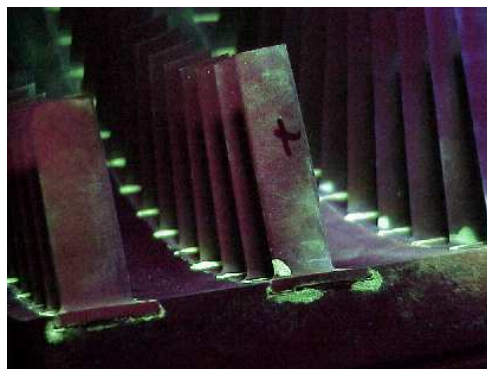
Inspection fluorescente sur des ailettes de turbine industrielle
